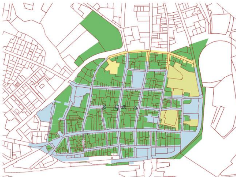
Figur 2-1 Projekts opland: bykernen. Med grønt ses de arealer der afleder til fællessystemet. Med blå ses de arealer der afleder til regnvandssystemet, med gult ses de arealer der nedsiver og med sort skravering ses de arealer der for nyligt er koblet tilbage på fællessystemet.
